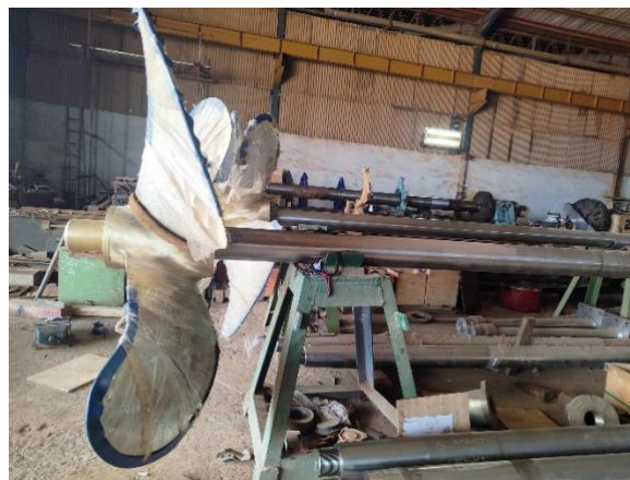
Gambar 3.6 Pemasangan Propeller pada shaft
