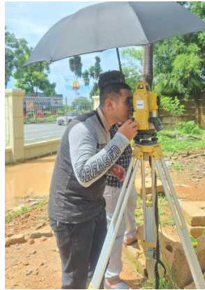
Gambar 4 Pengambilan Titik Uji Akurasi
