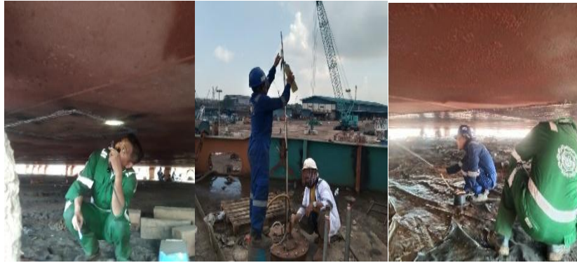
Gambar 8. Inspection Visual dan Air Pressure Test pada Lambung Kapal
