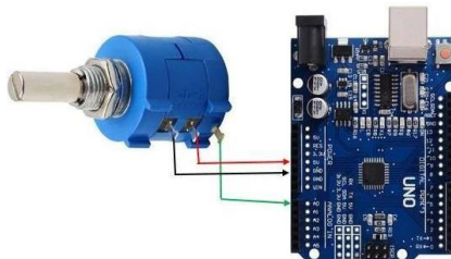
Gambar 3 Desain Elektrikal Sensor Feedback
