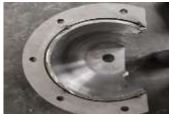
Gambar 14. Material holder shock setelah di bor
