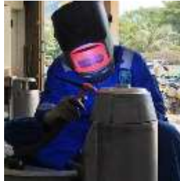
Gambar 15. Proses Assembly dengan metode pengelasan GTAW
