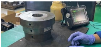
Gambar 2 : Alat UT dan Blok Kalibrasi UT
