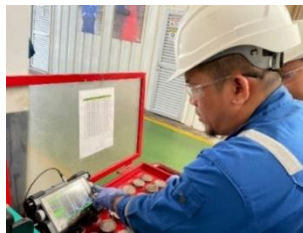
Gambar 1 : Proses Kalibrasi menggunakan Blok kalibrasi
