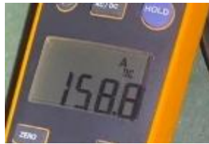
Gambar 25 Arus aktual filler sampel 6
