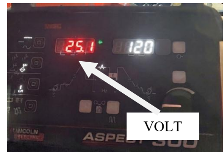
Gambar 13 Tegangan aktual sampel 3
