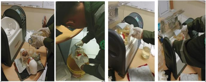
Gambar 21. Pengujian Tegangan Tembus
