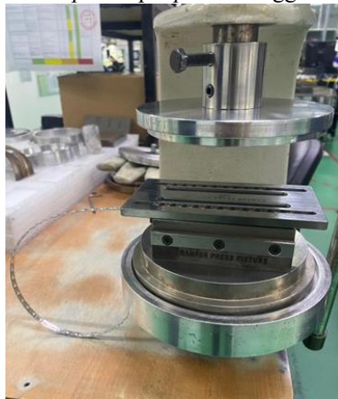
Gambar 18: Alat Press Fixture Terpasang di Arbor Press
