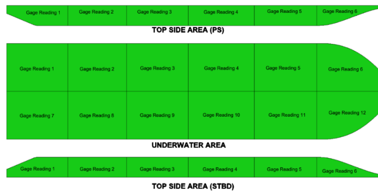
Gambar 7 Simulasi hasil akhir area pengukuran DFT Lapisan kedua
