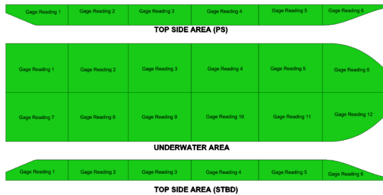
Gambar 6 Simulasi hasil akhir area pengukuran DFT Lapisan Pertama
