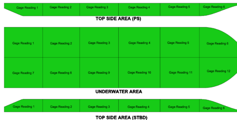
Gambar 8 Simulasi hasil akhir area pengukuran DFT Lapisan ketiga
