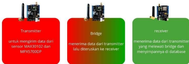
Gambar 3. 16. Blok Diagram Cara Kerja Komunikasi LoRa
