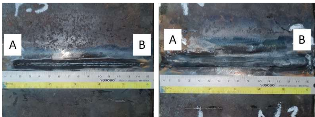
Gambar 4. 2. Hasil Pengelasan Bagian Root , (Sebelah Kiri Arus Single Pulse dan Sebelah Kanan Arus Konvensional)
