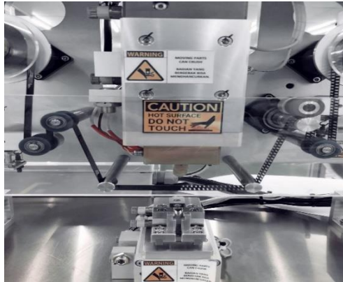
Gambar 17. Roller Tape dan Jig Stamping Unit (Sumber: Data industri)
