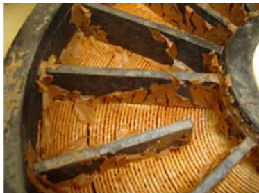
Gambar 2. 2 Scaling dan Fouling Membrane
