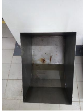
Gambar 7 .Media pendingin air garam
