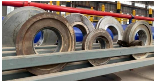
Gambar 8. Penyimpanan dies yang sembarangan (size yang bercampur, serta tidak ada indikasi).
