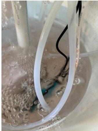
Gambar 17. Pemasangan sensor TDS dan pH
