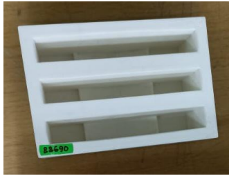
Gambar 9: jig difabrikasi menggunakan 3D printing
