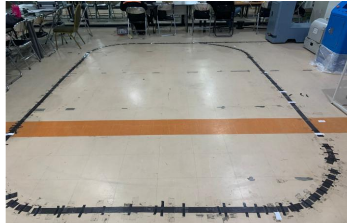
Figure 6. Lintasan Uji AGV Berbasis Jalur Magnetik dengan Penempatan Tag RFID
