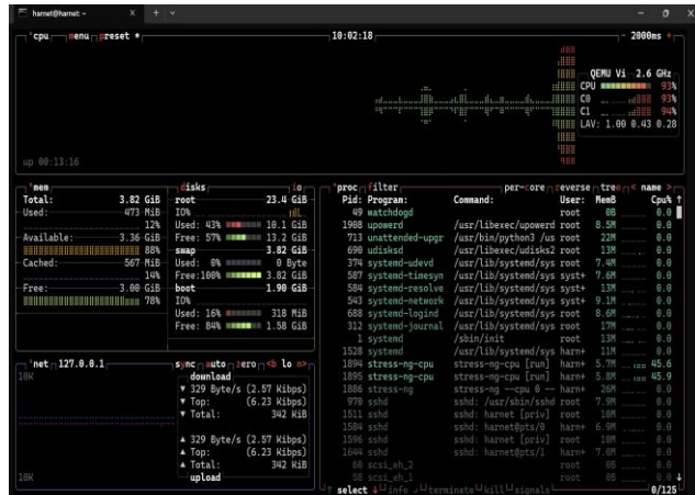
Gambar 14. Hasil pengukuran uji coba stress CPU
