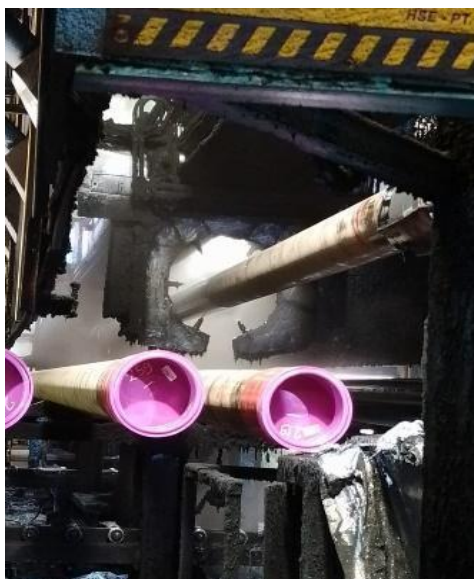
Gambar 1. Mesin Coating dengan Metode Airless Spray
