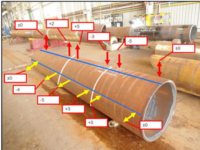
Gambar 7 Pengukuran Panjang, Kelurusan, dan Kerataan
