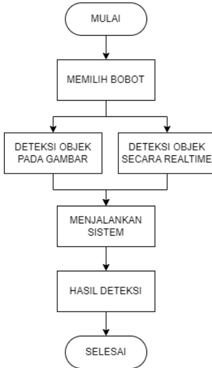
Gambar 12. Diagram Alur Sistem Pendeteksi Bentuk dan Warna
