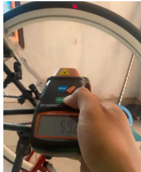
Gambar 8. Pengujian Performa Roda Menggunakan Tachometer Digital
