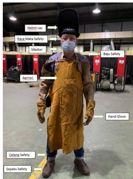
Gambar 4 Alat Pelindung Diri Saat Melakukan Las.
