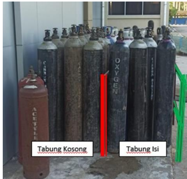
Gambar 9 : Tabung gas oksigen dan asteline di tempat area workshop welding
