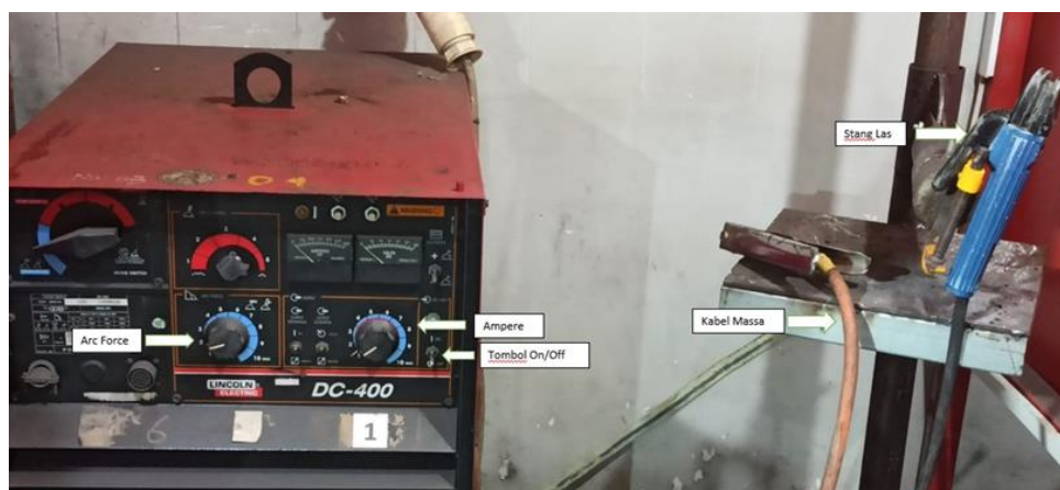
Gambar 5 Mesin Las Lincoln DC 400
