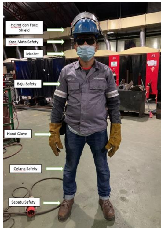
Gambar 8 : APD saat menggunakan cutting torch
