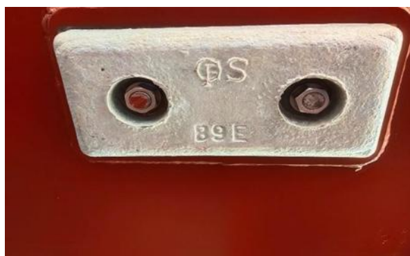
Gambar 3 Zinc Anode Kapal Crane Barge 68,40 meter
