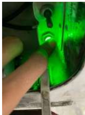
Gambar 7. Indikasi Indicator Light Cargo Door setelah perbaikan
