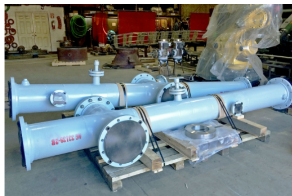
Gambar 4. Contoh hasil dari Pipe Spooling
