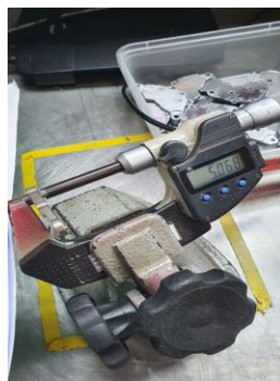
Gambar (e). Menggunakan micrometer untuk mengukur ketebalan spesimen.
