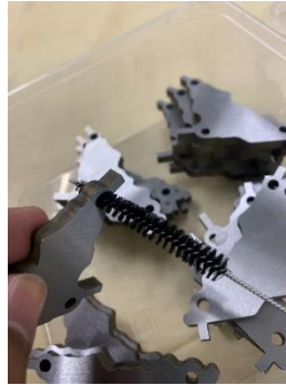
Gambar (a). Pembersihan kerak sisa material pada spesimen menggunakan brush spiral.
