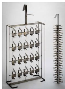
Gambar (c). Contoh rak JIG dan alat JIGGING
