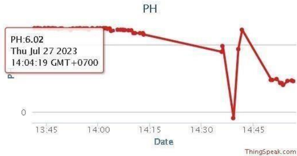
Gambar 4. 1 Nilai data sensor ph SKU SEN0161 di website ThingSpeak dalam bentuk graphic
