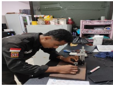
Gambar 4. Pengukuran dengan alat surface roughness
