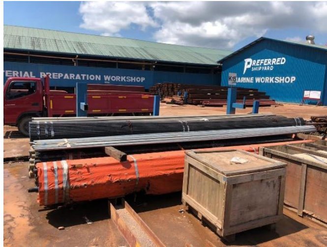
Gambar 14.11 Area penumpukan bundle piping
