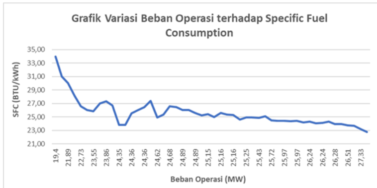
Gambar 5. Grafik Hubungan Beban Operasi Pembangkit terhadap SFC
