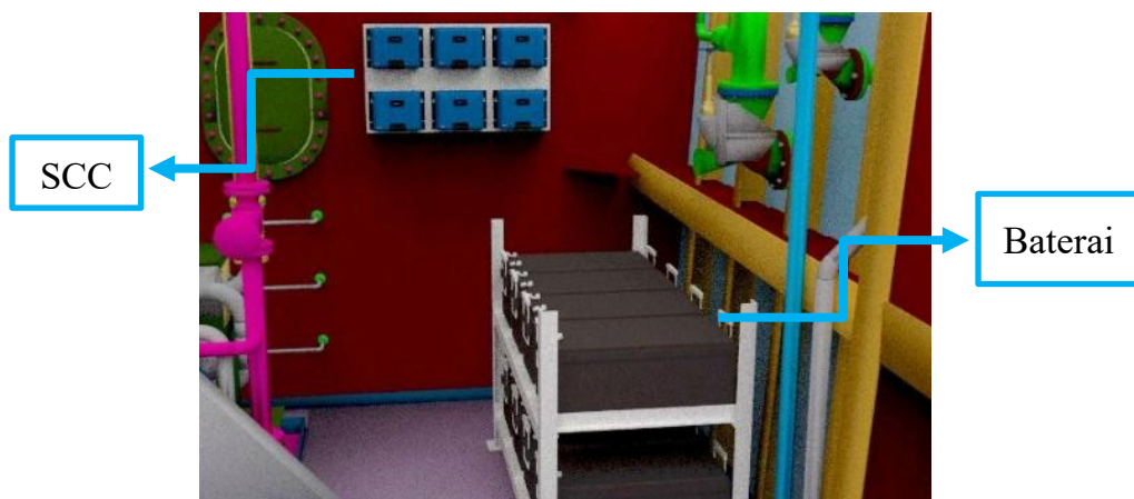
Gambar 5. Isometric peletakan SCC dan Baterai
