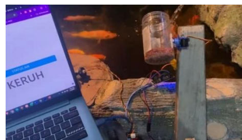
Gambar 16. Gambar Automatic Fish Feeder Terjadwal
