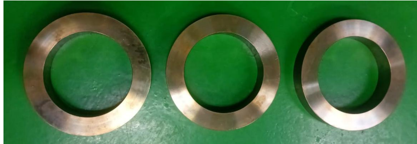
Gambar 5: Material yang telah diberikan aging hingga 3 siklus
