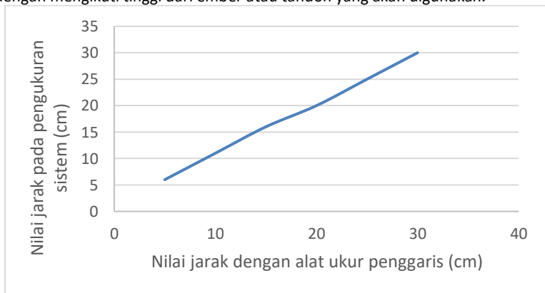
Gambar 16 Grafik Akuisisi data sensor HC-SR04t
