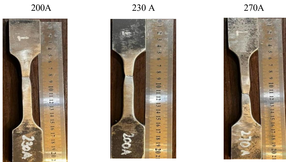
Gambar 10. Pola patahan Spesimen Uji Tarik Pada ketiga Variasi arus
