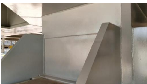
(a) Spesimen Baja ASTM SA516 Grade 65N untuk Dry Film Thickness .
