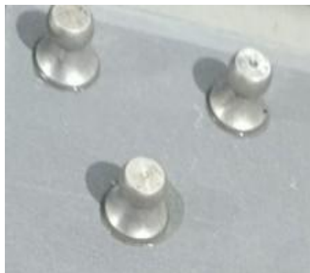
Gambar 3.7 Pemasangan Dolly berukuran 20 mm.
