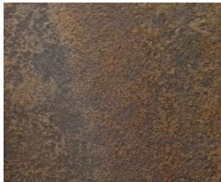
(a). Permukaan Baja Sebelum Proses Blasting .
