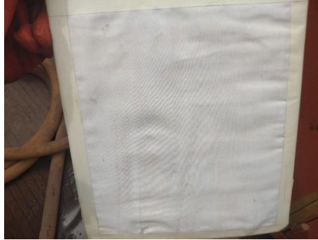
Gambar 3.1 Hasil Tekanan Pengujian Pengetesan Udara Menggunakan Blotter test.
