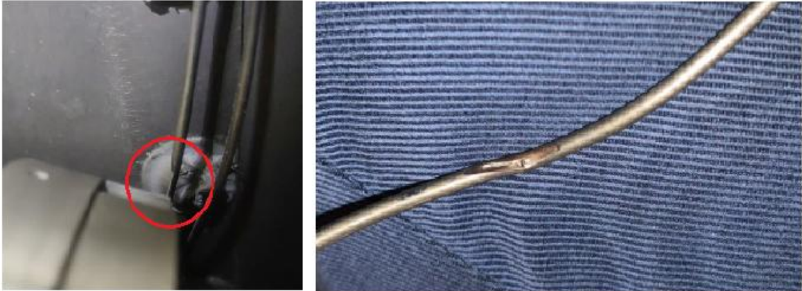
Gambar 11: Dokumentasi Engine Fire Loops Chafing pada Pesawat ATR 72-500 PK-WFQ
