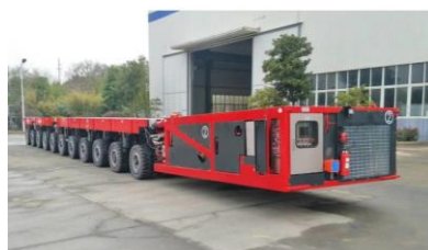
Gambar 2. Alat Berat Mesin SPMT (Sumber : Anster, 2016)
