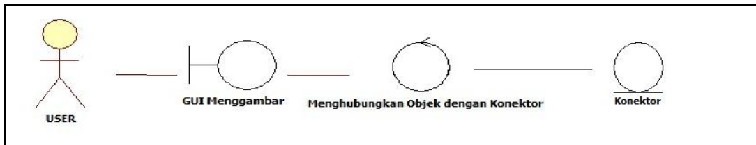
Gambar 7. Robustness Diagram Use Case menghubungkan satu objek dengan objek lainnya menggunakan konektor
