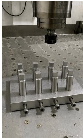
Gambar 3. Proses Pemasangan Benda Kerja pada Jig Pin Pusher Wave Pallet
