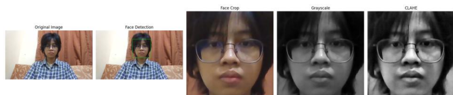
Gambar 4.17 Tahapan preprocessing wajah pada sistem face recognition
