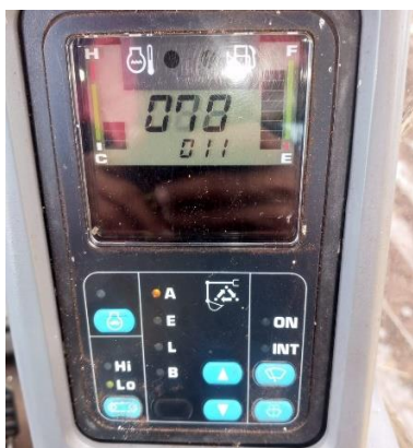
Gambar 6 Tampilan nilai tekanan monitor panel (setelah perbaikan)
