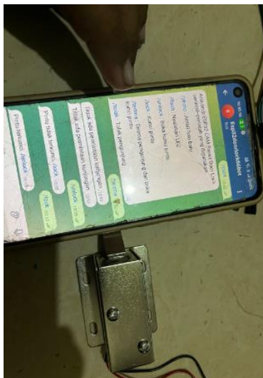
Gambar 19. Tampilan Telegram dan selenoid ketika mengunci pintu
