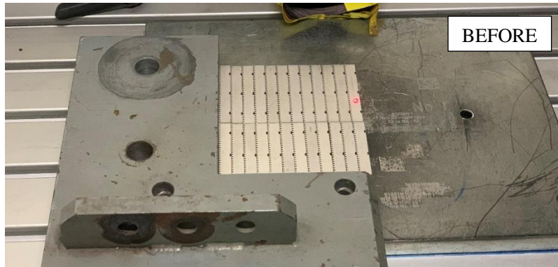
Gambar 10: Proses lama yang menggunakan Besi Penahan Strip
