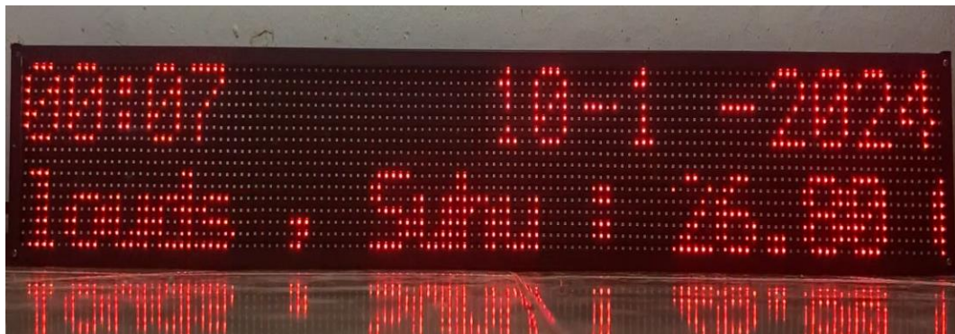
Gambar 7. Tampilan Data Cuaca yang ada pada LED Matriks
