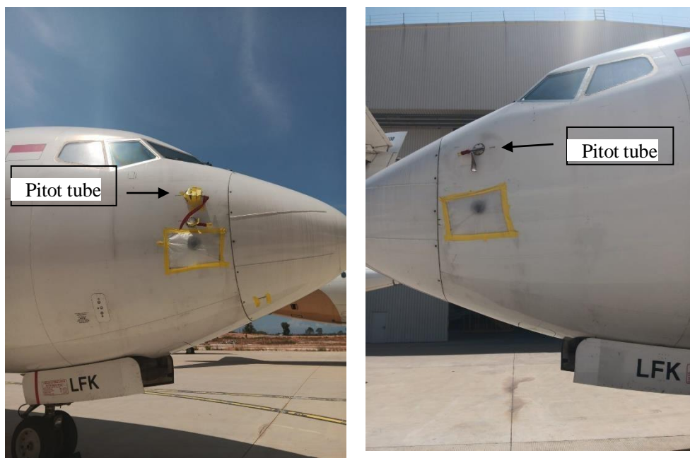
Gambar 1: Contoh Pitot Tube Location pada pesawat Boeing 737-900
