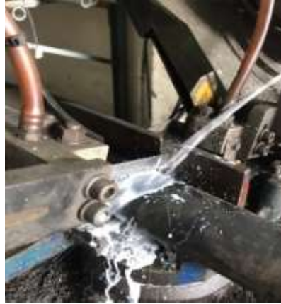
Gambar 2 : Proses Pemotongan Pipa Menggunakan Mesin Gergaji Duduk
